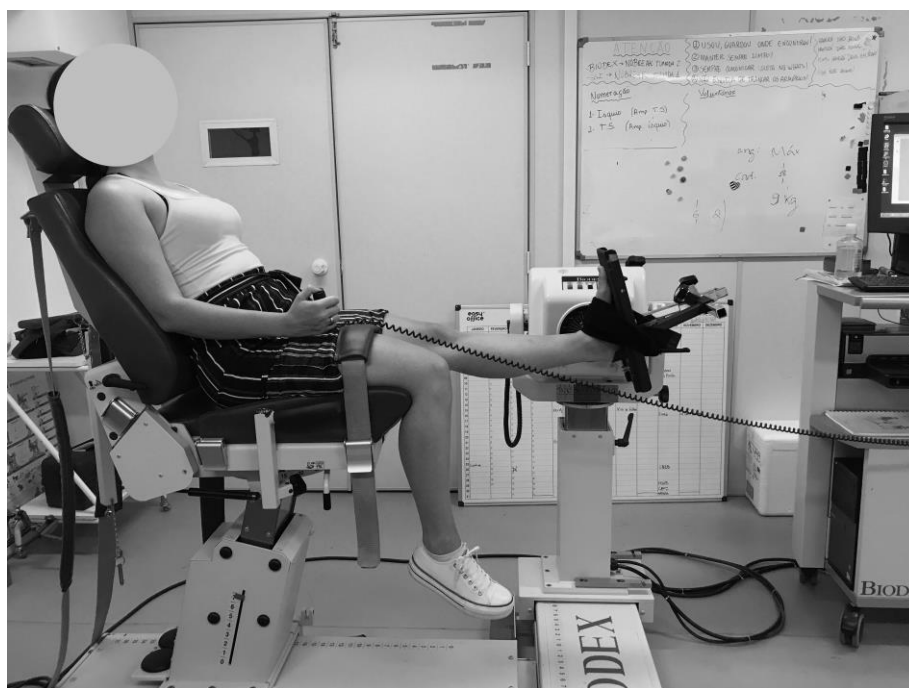
Figura 10. Posicionamento do voluntário no dinamômetro isocinético para análise da ADM máxima da dorsiflexão.
