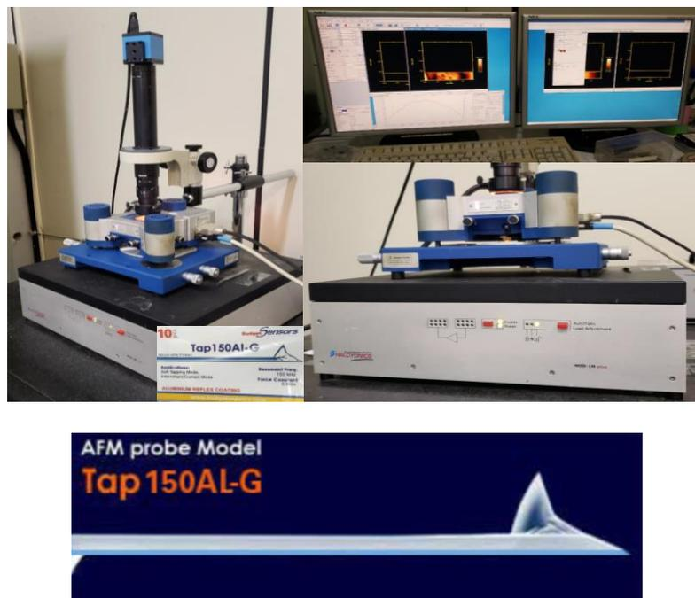
Figura 32: Imagem de um microscópio de força atômica JPK. Equipamento destinado à análise das propriedades mecânicas das ACUs.
