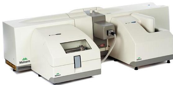
Figura 30: Imagem de um Mastersizer Malvern 2000. Equipamento destinado à análise do tamanho e dispersão das ACUs.
