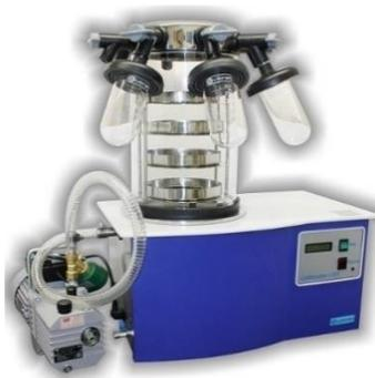
Figura 25: Imagem de um Liofilizador Liotop L101. Equipamento destinado a liofilização das ACUs.
