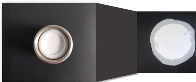
Figura 53: Foto do filtro de náilon após a primeira filtração. Os grumos remanescentes permanecem aderidos ao filtro, que é deixado para secar e então pesado novamente para estimativa do percentual retido.
