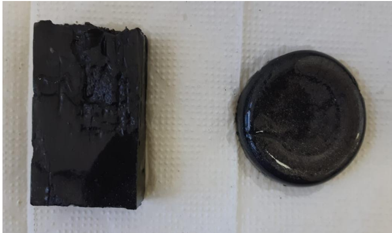
Figura 9. Phantom (Ph10) de 2% de ágar com 5% de pó de grafite.
