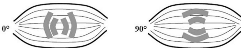
Figura 37. Arranjo de eletrodos (cinza) posicionados longitudinalmente as fibras musculares (esquerda) e transversalmente as fibras musculares (direita) (Rutkove 2009).
