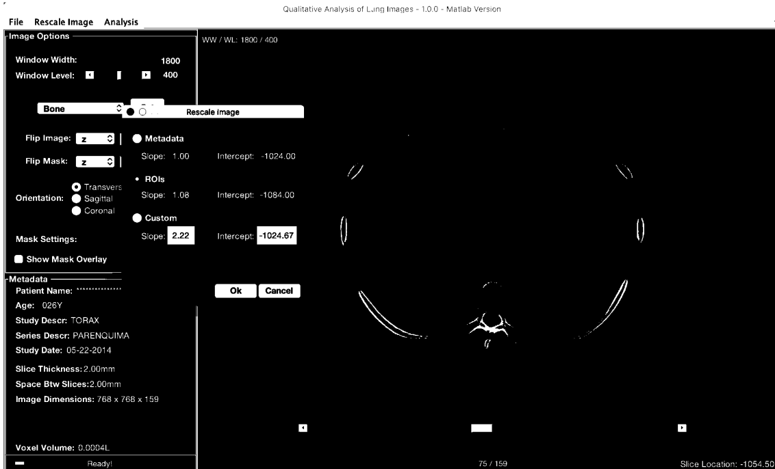
Figura 5.33: Interface principal do software desenvolvido no presente trabalho juntamente com a janela de diálogo que contém as opções de rescalonamento dos voxels. O círculo azul representa a área de amostragem de conteúdo com ar e o círculo vermelho representa a área de amostragem da aorta descendente.
