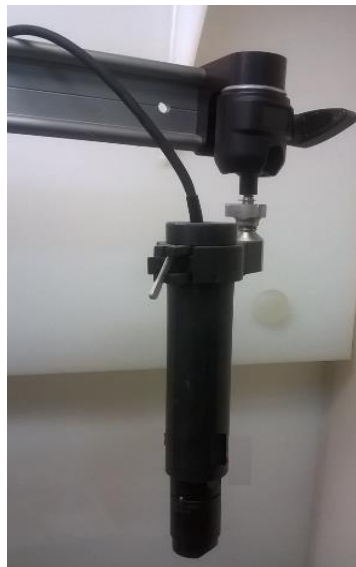
Figura 9. Transdutor de focalização esférica do equipamento de biomicroscopia ultrassônica (BMU) do Laboratório de Ultrassom (LUS/PEB/COPPE/UFRJ). Fonte: fotografia realizada pela autora.
