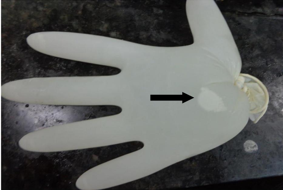
Figura 11: Luva preenchida com água da torneira. Destaque para as bolhas em seu interior, indicadas pela seta preta, formadas a partir da radiação ultrassônica. As imagens foram obtidas após irradiação de  $3 \text{ W/cm}^2$  de intensidade por um minuto.
