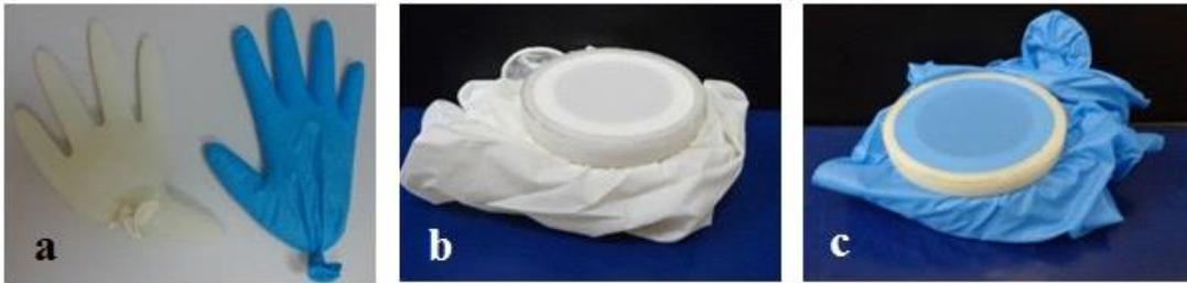
Figura 1: a) aspecto das luvas de látex e de nitrila preenchidas com água; b) Luva de látex no limitador da altura; c) luva de nitrila no limitador de altura.
