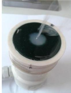
Figura 8: Corpo de prova sendo irradiado por transdutor de 1 MHz com intensidade de  $1,0 \text{ W/cm}^2 \pm 0,1$ . Observa-se a fumaça sendo provocada pela queimadura no corpo de prova.
