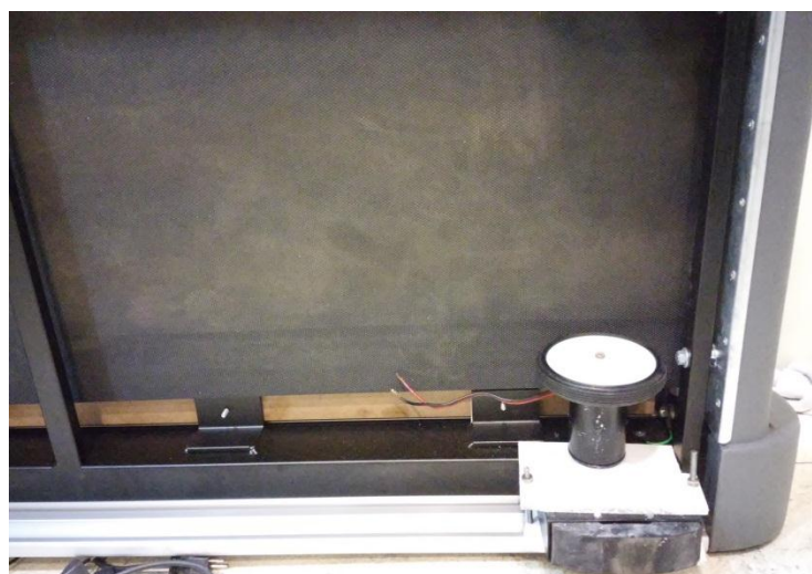
Figura 9: Parte inferior da esteira, local de fixação do pneu e do motor.
