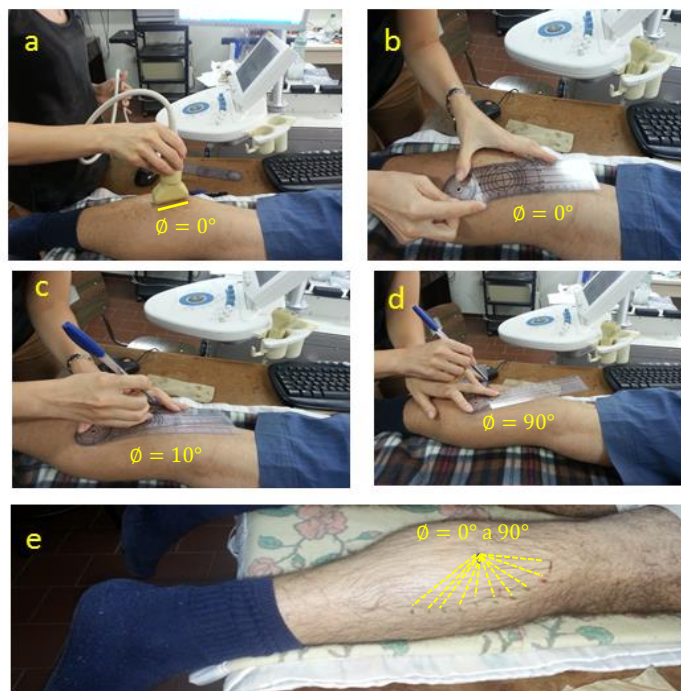
Figura 31: Etapas da marcação de dez posições para acoplamento do probe , com distintos ângulos \emptyset ( 0 - 90^\circ ) no plano x_2 - x_3 . a) probe na posição \emptyset = 0^\circ , b) goniômetro na posição inicial ( \emptyset = 0^\circ ), c) goniômetro na posição \emptyset = 10^\circ , d) goniômetro na posição \emptyset = 90^\circ , e) marcações para as dez posições do probe . Note que as fotos de a-d equivalem ao músculo esquerdo e a foto e , ao direito.
