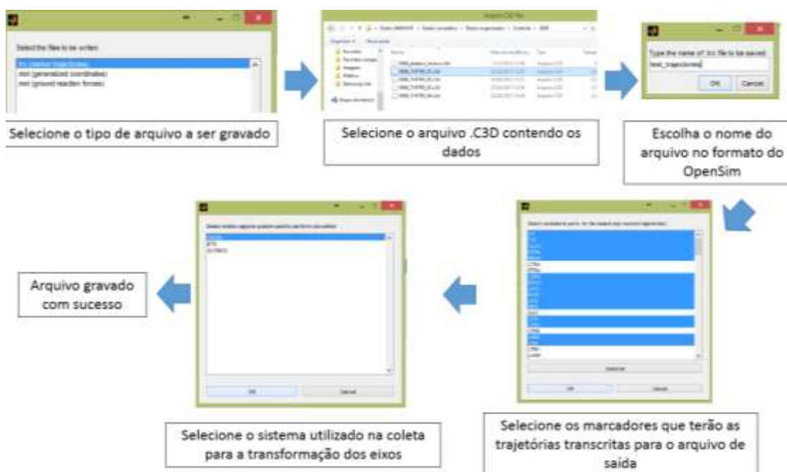
Figura 10: Fluxograma, mostrando as principais etapas da conversão dos dados das trajetórias dos marcadores para o formato solicitado pelo OpenSim.
