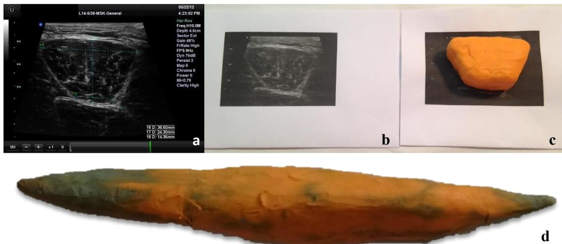
Figura 3.2: Sequência para fabricação da matriz do *phantom*. a – imagem de ultrassom exportada do aparelho para um computador, b – imagem impressa, c – segmento de plastilina sobre a imagem e d – matriz em plastilina.
