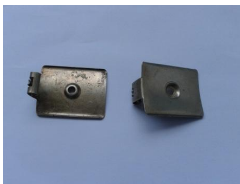
Figura 4.1 - Eletrodos utilizados na aquisição dos dados de BIS
