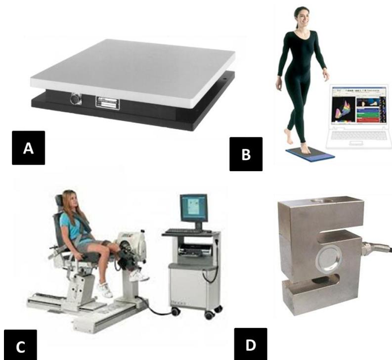
**Figura 3.3:** Exemplos de sistemas de mensuração de variáveis dinâmicas. A: Plataforma de Força; B: Baropodômetro (Plataforma de Pressão); C: Dinamômetro Isocinético; D: Célula de Carga.
