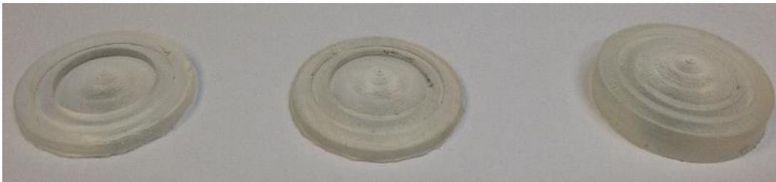
Figura 5.7 – Lentes de Fresnel de silicone confeccionadas com o molde da Fig. 5.5.
