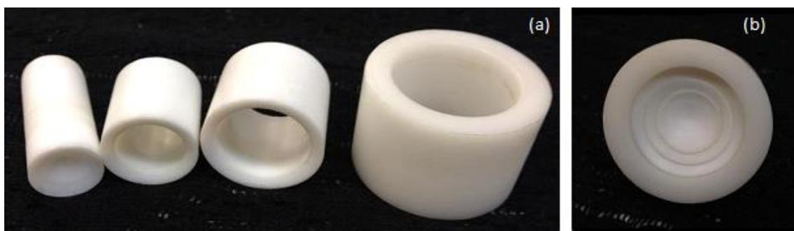
Figura 5.5 – Molde de teflon para a confecção das lentes de Fresnel de silicone: a) desmontado; b) montado.
