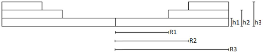
Figura 5.2 – Projeto da lente escalonada de alumínio I para a frequência de 3 MHz com raios  $R1 = 6,93$  mm,  $R2 = 9,70$  mm e  $R3 = 15$  mm e degraus 1, 2 e 3 com alturas  $h1 = 1,07$  mm,  $h2 = 2,14$  mm e  $h3 = 3,21$  mm, respectivamente.
