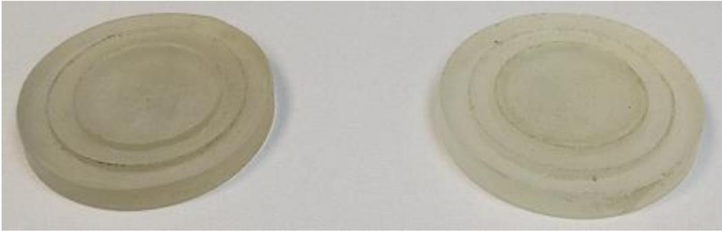
Figura 5.6 – Lentes de Fresnel de epóxi confeccionadas com o molde da Fig. 5.4.
