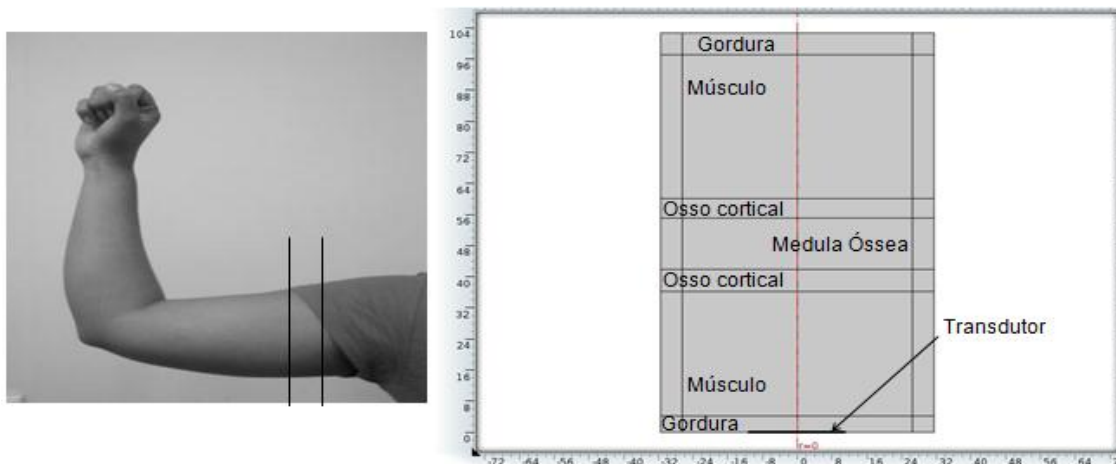
Figura 11: Geometria adotada para simulações em camadas de tecidos biológicos com espessuras reais de terço médio de braço (gordura / músculo / osso cortical / medula óssea).
