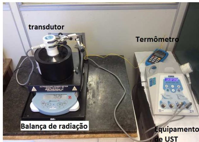
Figura IV.9– Arranjo experimental para medição da potência ultrassônica dos equipamentos de UST.
