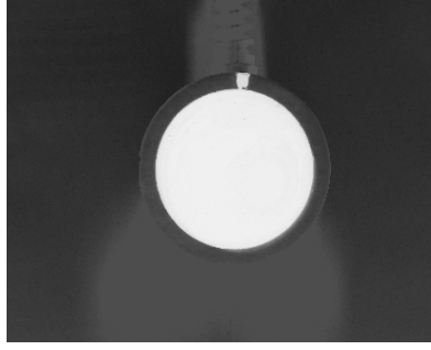
Figura C2- Imagem invertida de escala de cinza - o que era mais escuro fica mais claro e vice-versa. Utilizado para calcular o complemento da imagem.
