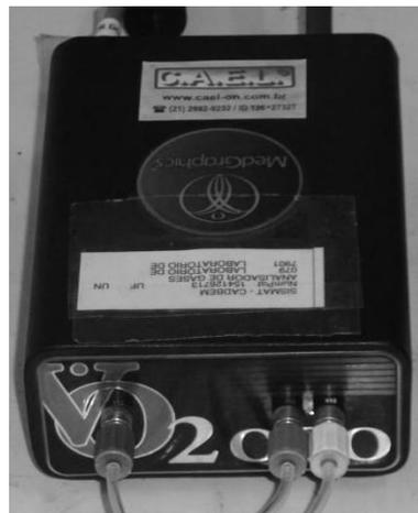
**Figura III.3 – Analisador de trocas gasosas VO2000.**
