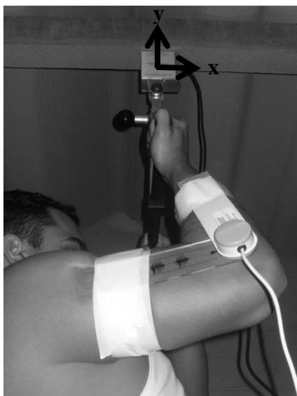
**Figura III.1 – Barra fixa em série com a uma célula de carga uniaxial(y) e goniômetro digital sobre a articulação umeroulnar.**
