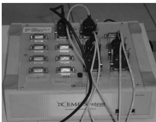
**Figura III.2 – Conformador de sinais. Os sinais de dinâmometria, goniometria e eletromiografia foram coletados simultaneamente.**
