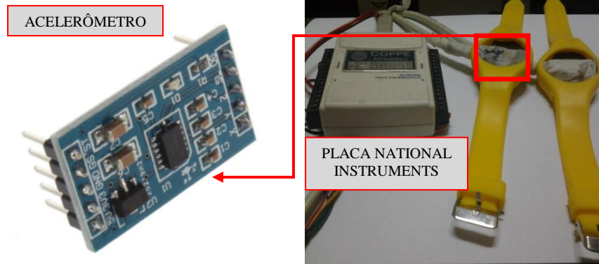
Figura 4.5: Acelerômetro tri-axial modelo MMA 7361 (Freescale, Estados Unidos) acoplado a pulseira de relógio (suporte) e conectado a Placa de aquisição da National Instruments (NI USB – 6009).
