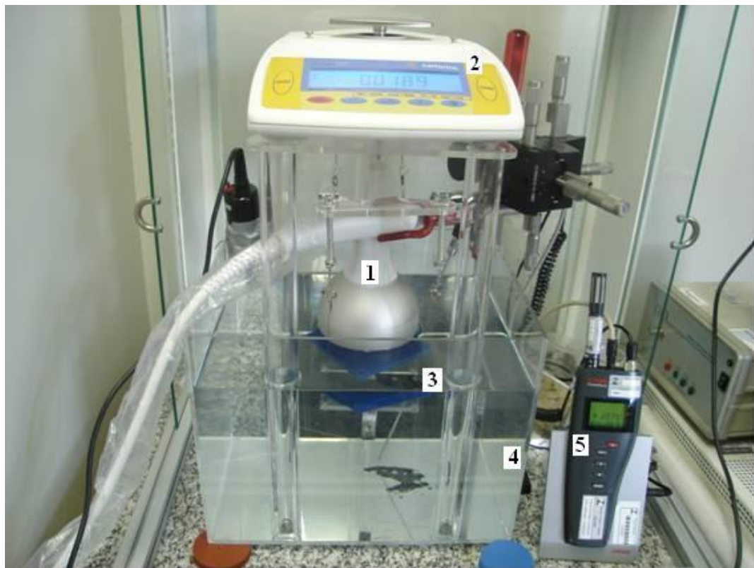
Figura 2.5 – Balança de potência ultrassônica utilizada no Inmetro: 1- Transdutor de emissão, 2- Balança, 3- Alvo absorvedor, 4- Tanque com água, 5- Medidor de temperatura e umidade.
