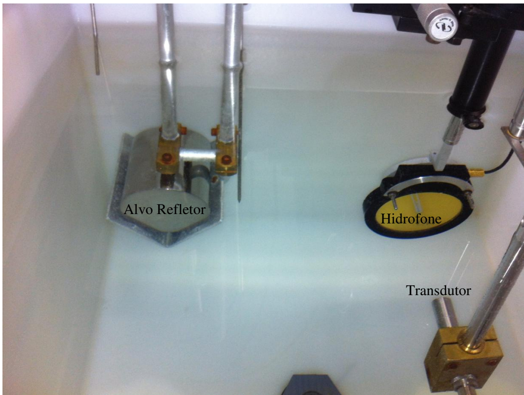
Figura 4.3 – Arranjo experimental de medição com o alvo refletor, hidrofone e transdutor de emissão submersos em água no tanque acústico.
