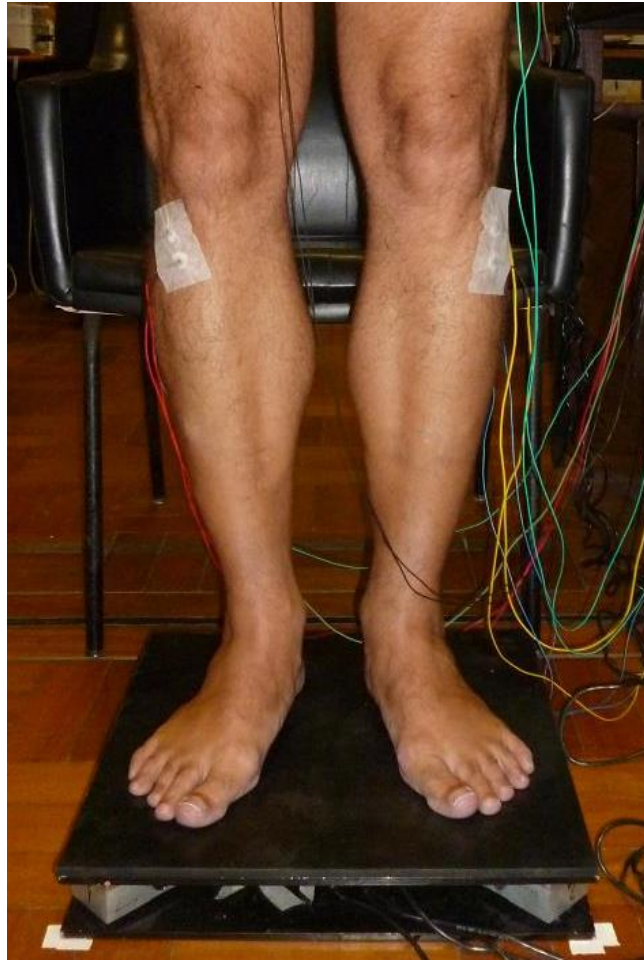
Figura 4.5: Eletrodos EMG posicionados nos músculos tibial anterior direito e esquerdo com o voluntário sobre a plataforma de força utilizada no experimento.
