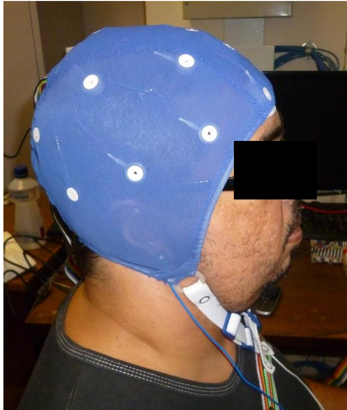
Figura 4.3: Touca modelo ECI Electro-Cap Electrode System TM , utilizada para a aquisição dos sinais EEG.
