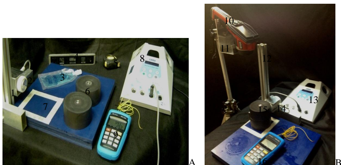
Figura 15: A) Detalhes dos equipamentos empregados na avaliação da distribuição da energia térmica no Phantom anatômico do terço médio do braço com e sem implantes metálicos após a irradiação por UST e B) Aspecto final da montagem experimental na avaliação da distribuição da energia térmica no Phantom anatômico do terço médio do braço com e sem implantes metálicos empregando termografia. Os equipamentos são numerados sequencialmente como 1) Suporte para o transdutor de UST; 2) Transdutor de UST; 3) Gel clínico a base d'água; 4) Nível; 5) Trena; 6) Phantom (duas metades); 7) Base de apoio; 8) Equipamento de UST; 9) Termômetro Digital; 10) Câmera infravermelha; 11) Tripé; 12) Suporte para o transdutor de UST; 13) Equipamento de UST; 14) Transdutor de UST; 15) Phantom e 16) Termômetro Digital.
