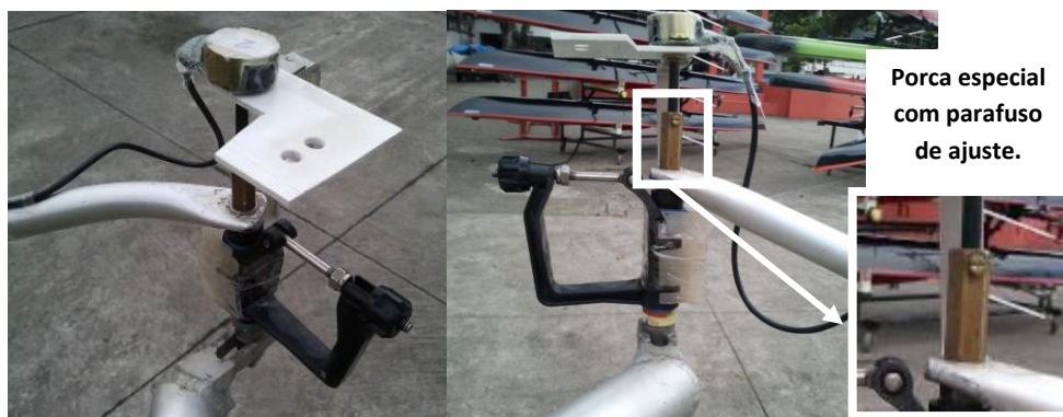
Figura 43 – Instalação dos goniômetros potenciométricos para medida de deslocamento angular horizontal dos remos.
