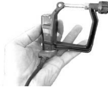
Figura 24 – Forqueta modificada para medida de força e posição angular dos remos. Power Line Rowing Instrumentation . Extraído de Peach Innovations (2010).
