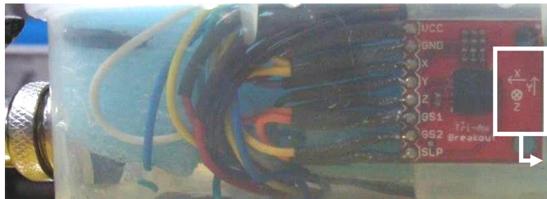
Figura 36 – Posicionamento do sensor para monitoramento da aceleração do barco no sistema desenvolvido. Os eixos X, Y e Z representam surge , heave e sway , respectivamente.
