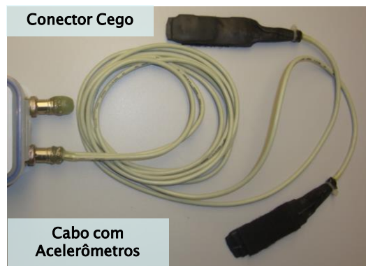
Figura 31 – Numa das conexões externas está o cabo com acelerômetros para monitoramento do movimento do carrinho e do tronco do remador, na outra conexão, está o conector de proteção.
