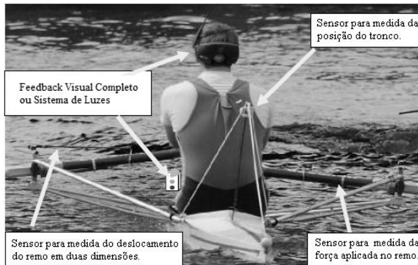
Figura 23 – Instrumentação comercial com sistema de telemetria e sistema de luzes para feedback imediato BioRowTel v4.0. Imagem gentilmente cedida por BioRow, 2012.
