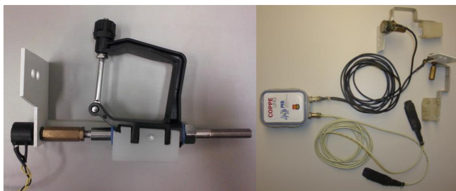
Figura 32 – Da esquerda para direita: Goniômetro potenciométrico para medida de amplitude de remada e sistema completa com todos os sensores externos desenvolvidos.
