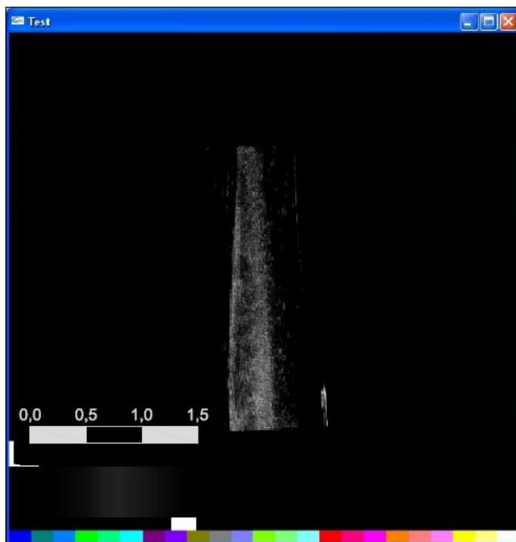
Figura 4.6: Imagem 3D de ultrassom do phantom 2 , gerada a partir de um conjunto de imagens 2D processadas com o programa em Python. Essa imagem mostra a forma cônica da parte interna do phantom . A escala está em centímetros.
