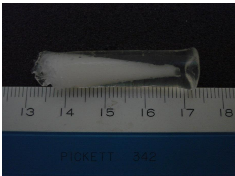
Figura 3.20: Foto do phantom 2 . Sua parte interna foi moldada com a ponteira de uma micropipeta de formato cônico e seu formato é cônico
