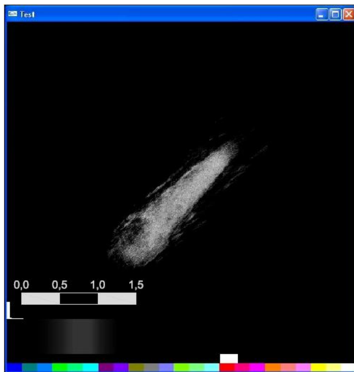
Figura 4.4: Imagem de ultrassom do phantom 1 em 3D, com vista em diagonal. Pode-se observar a forma cônica do phantom . A escala está em centímetros.
