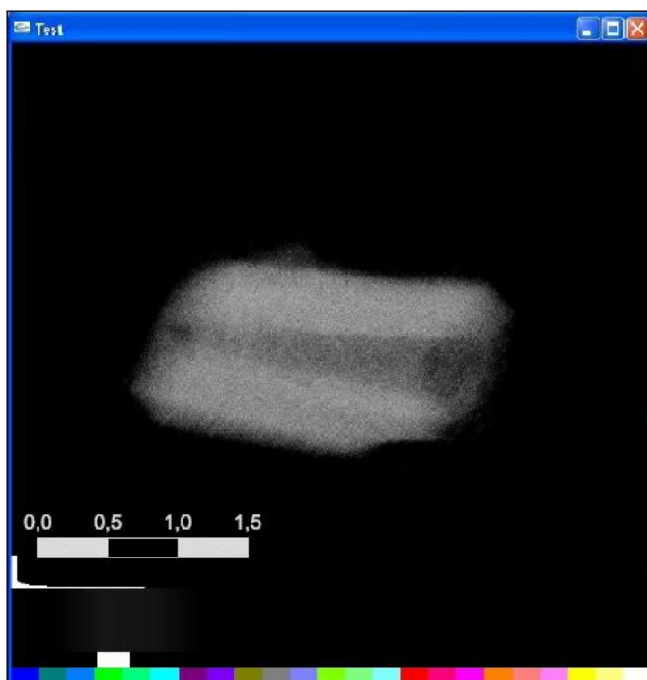
Figura 4.13: Imagem 3D de ultrassom do phantom 3. Nesta vista pode-se observar a forma cônica da parte interna do phantom que é anecoica. A escala está em centímetros.
