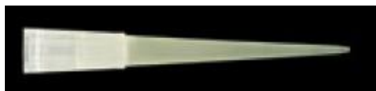
Figura 3.17: Ponteira de micropipeta com volume variável entre 1 e 200 \mu\text{L} da marca Plast Labor.
