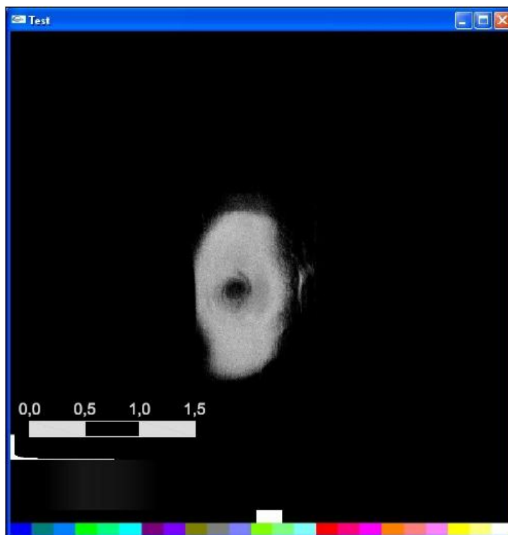
Figura 4.12: Imagem 3D de ultrassom do phantom 3 com vista frontal. Pode-se observar o orifício, anecoico, correspondente à parte interna do phantom que foi moldada pela ponteira (cônica) de uma micropipeta. A escala está em centímetros.
