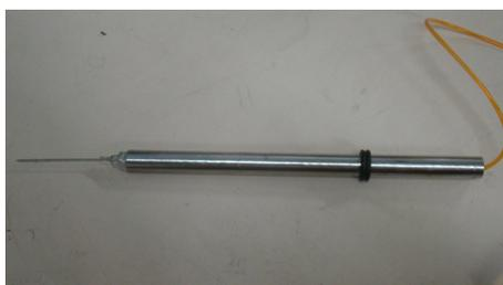
Figura 3.3: Tubo metálico para fixação da agulha.
