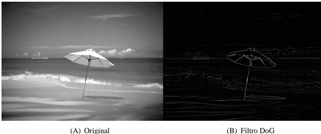
Figura 2.9 - O filtro DoG (B) destaca as bordas quando há subtração de duas gaussianas de diferentes desvios-padrão.
