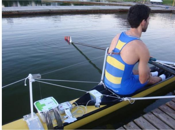
**Figura 44: Sistema de aquisição de dados biomecânicos montado na íntegra.**
