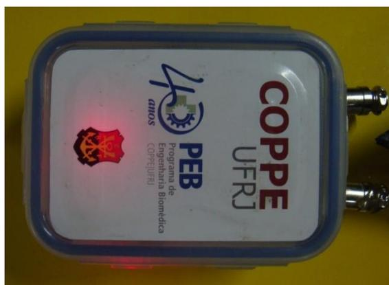
**Figura 39:** Foto do sistema de aquisição de dados biomecânicos de remo do LIB mostrando as duas entradas para sinais externos. As dimensões da caixa são 10 cm x 13 cm x 7 cm.
