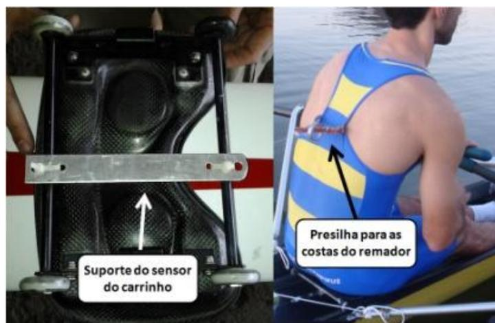
**Figura 43:** À esquerda é mostrado o suporte que fica fixado embaixo do carrinho, preso por lacres plásticos ao redor dos eixos das rodinhas. À direita é mostrada a presilha presa ao tronco do remador que mantém a extremidade do fio aproximadamente na altura da vértebra T7.
