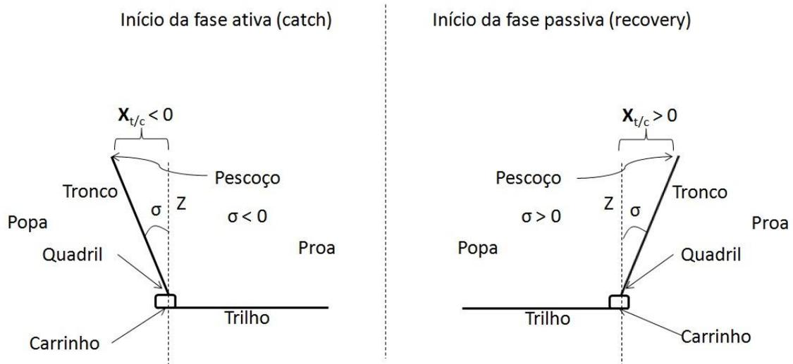
Figura 24: Visão lateral do diagrama de corpo livre do tronco do remador em dois momentos do ciclo da remada: a esquerda tem-se o início da fase ativa e a direita o início da fase passiva.  $X_{t/c}$  é a posição do tronco do remador em relação ao carrinho ( $X_{t/b} - X_{c/b}$ ) cuja porção positiva é com o tronco inclinado à proa e a negativa e com o tronco inclinado à popa. Por definição do ângulo  $\sigma$ , este segue a mesma regra, tendo como linha de base o eixo Z.
