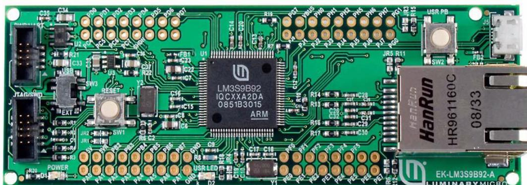
Figura 3.1.9: Placa de desenvolvimento com LM3S9B92 usada para controle do foto-estimulador.
