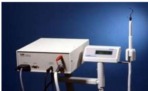
Figura 20: Electronic Caries Monitor (ECM ® ). Retirado de KLINKE et al. (2002)(com permissão).
