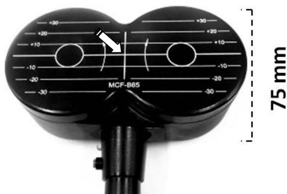
**Figura IV.1:** Exemplo de bobina em “oito” ou “borboleta”. A intersecção entre as bobinas, destacada pela seta, identifica o sítio onde se alcança a maior intensidade de campo.
