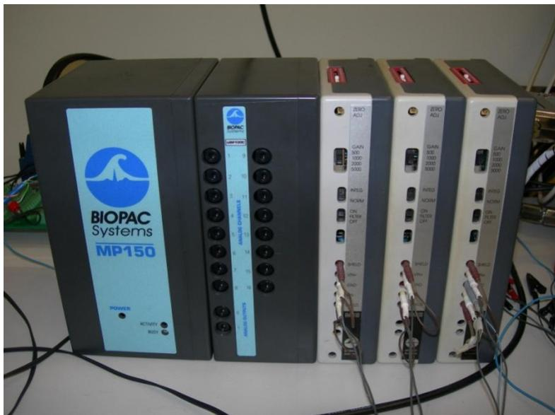
**Figura V.4:** Sistema de amplificadores de EMG e conversor A/D utilizado no processo de aquisição de sinais.
