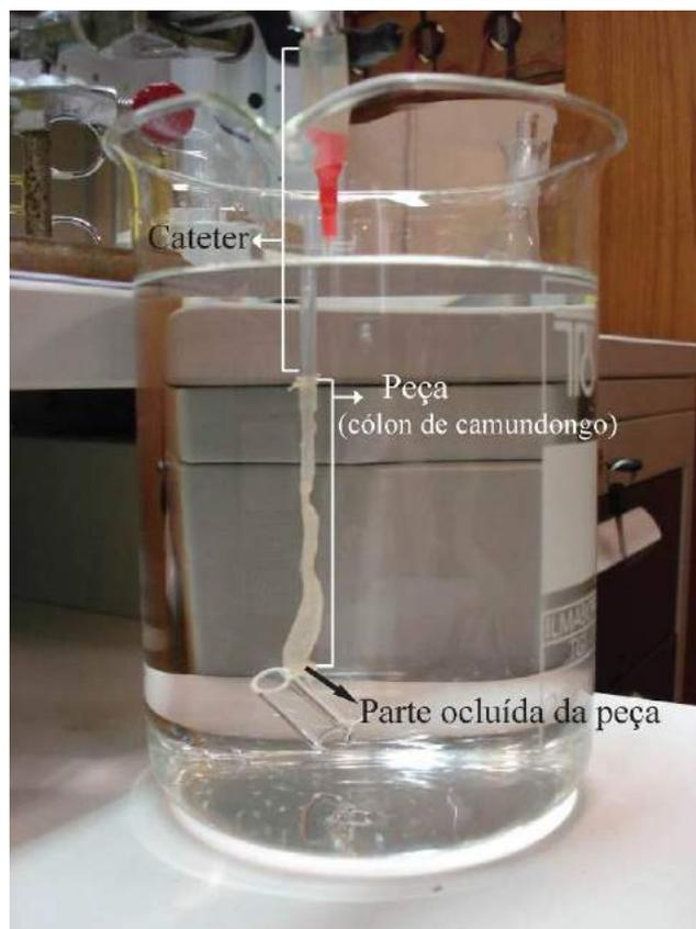
**Figura III.9 - Detalhes da montagem experimental contendo a peça anatômica do cólon de camundongo, imerso em água, e presa a um cateter que forma uma coluna de água. Observa-se a extremidade que foi ocluída por sutura e a outra, proximal, presa ao cateter por onde é inserida a minissonda de ultrassom.**
