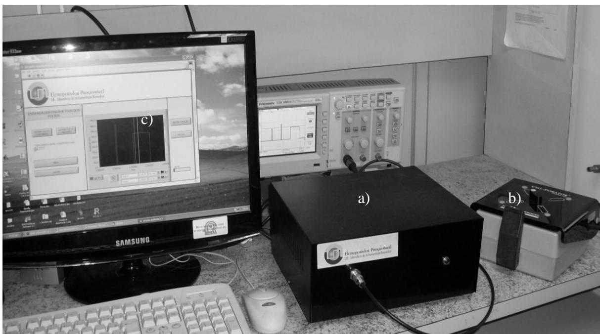
Figura 5-1 – Sistema de eletroporação desenvolvido. a) eletroporador; b) suporte para as cubetas; c) programa de controle. Ao fundo um osciloscópio TDS1001 (Tektronix, EUA) para registrar os pulsos gerados pelo eletroporador.
