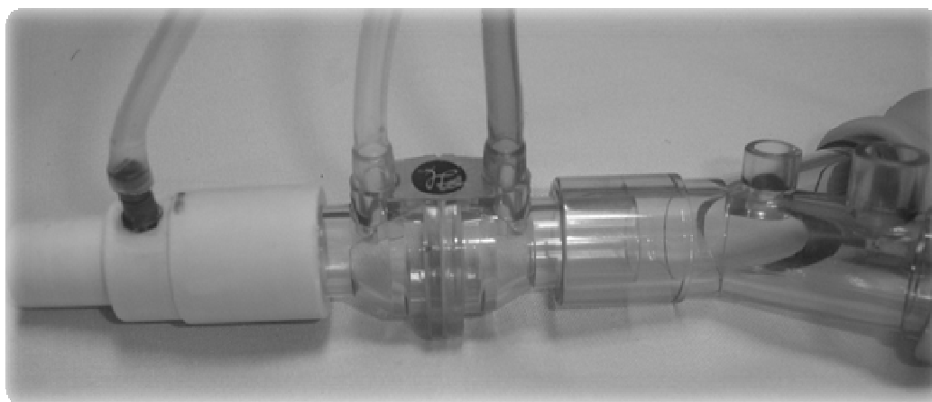
Figura 3.2 Disposição das conexões para medida de pressão de vias aéreas e fluxo. A tomada de pressão de vias aéreas (conector branco) é conectada entre o tubo endotraqueal e o pneumotacógrafo de orifício variável (conector em azul) posicionado entre a tomada da Paw e o “Y” do circuito de ventilação.
