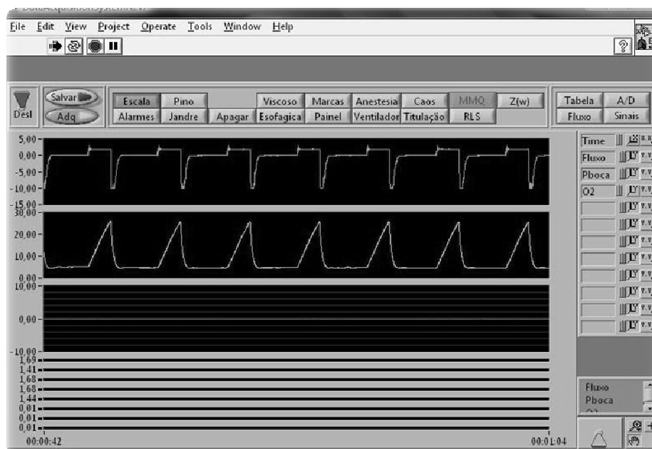
Figura 3.6 Tela do monitor do Data Acquisition System (DAS) durante aquisição de sinais de Fluxo (sinal superior) e Paw (sinal inferior).
