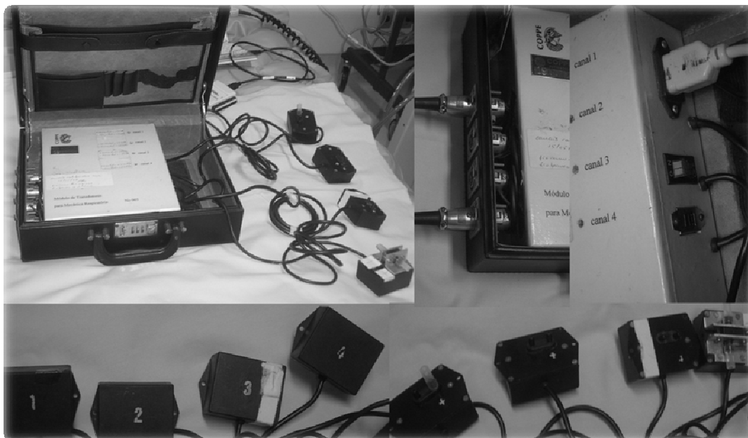
Figura 3.4 Vista panorâmica do Módulo de Transdutores para Mecânica Respiratória (MOTRAMERE) nº 005 utilizado para aquisição dos sinais. Módulo composto por 3 transdutores de pressão numerados de 1 a 3, um transdutor de pressão diferencial nº4 e o sistema para pré-condicionamento dos sinais.
