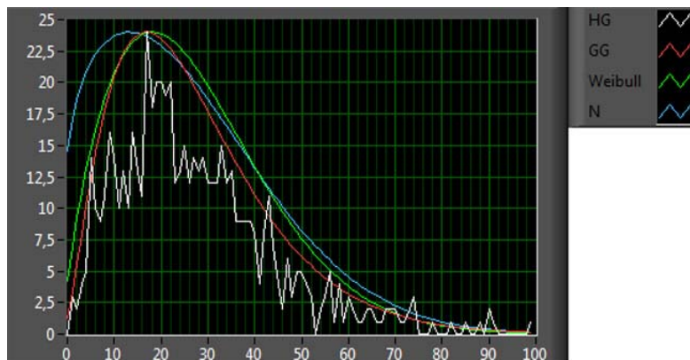
Figura AII.21 – Histograma e curvas de PDF ajustadas para uma amostra de CBC N2. Branco: histograma; Vermelho: GG; Verde: Weibull; Azul: Nakagami.
