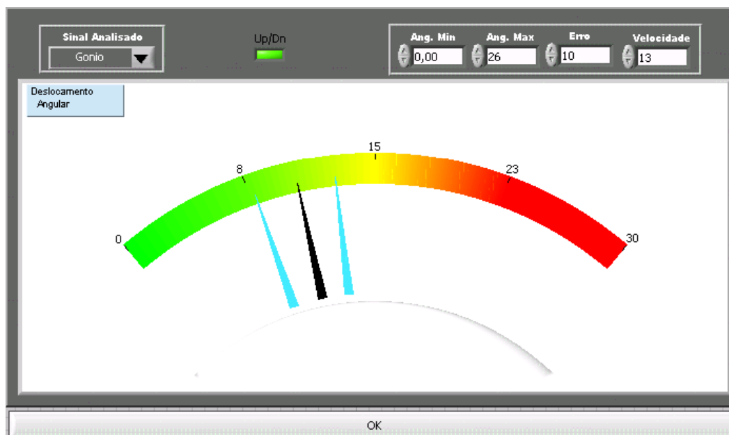
Figura 4.4 – Programa para realimentação visual da posição do braço e controle da velocidade angular, sendo o movimento dos ponteiros claros o alvo para o ponteiro escuro.
