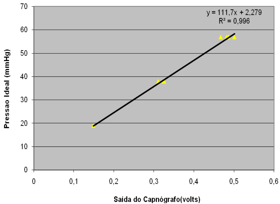
Figura 16 - Curva de Calibração para o Sinal de PETCO 2 . Pressão (mmHg) x Tensão (Volts). Os triângulos correspondem às 10 medidas experimentais para as concentrações de 2,5%, 5,0% e 7,5% de CO 2 , respectivamente.
