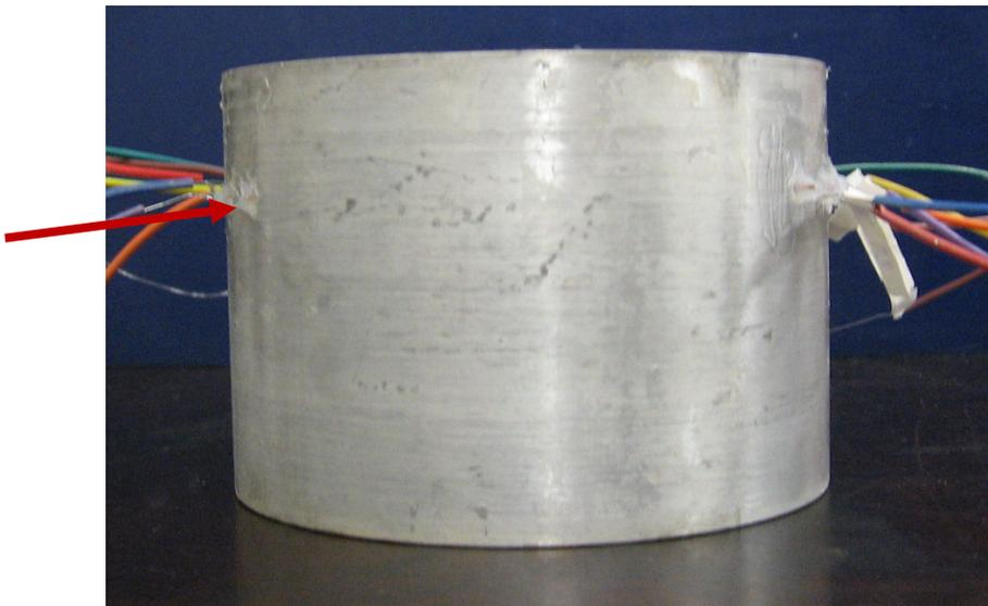
Figura 3.1.2.4 - Tubo (vista lateral), Nesta posição é possível ver a cola de silicone utilizada para fixação dos fios à parede do tubo, bem como o posicionamento dos fios em relação à altura do tubo.
