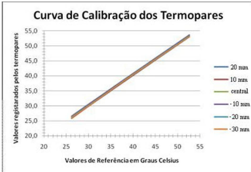
Figura 3.1.2.5 – Curva de calibração dos termopares.
