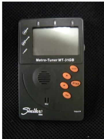
Figura 3.3.9 – Metrônomo utilizado para auxiliar na sincronização da velocidade de varredura do transdutor sobre o *phantom*.
