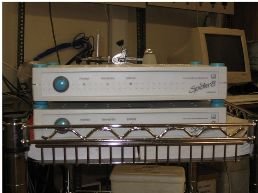
Figura 3.2.1.2 - Dispositivo para aquisição de sinais Spider 8 (vista do painel frontal).
