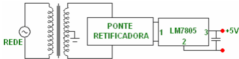
Figura 3.14 - Topologia para fonte de 5 V do motor. Para o encoder , o pino 2 do LM7805 está aterrado.
