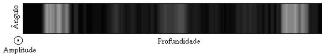
Figura 3.40 - Imagem em escala de cinza formada por 100 linhas do modo-A, referenciada a um sistema de coordenadas polares, gerada a partir do sinal de eco representado na Figura 3.39. O eixo horizontal corresponde à distância radial, ou em profundidade, e o eixo vertical ao ângulo da coordenada polar.
