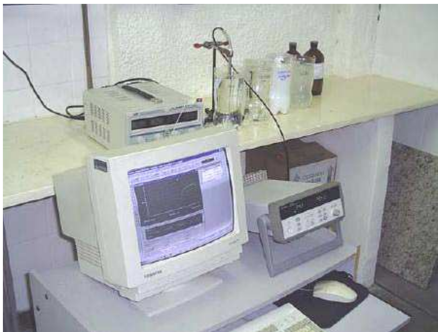
Figura III.21 – Montagem Experimental do Método da Sonda Linear no UNIMET/LTTC com a Sonda TP-02 ( Hukseflux ).
