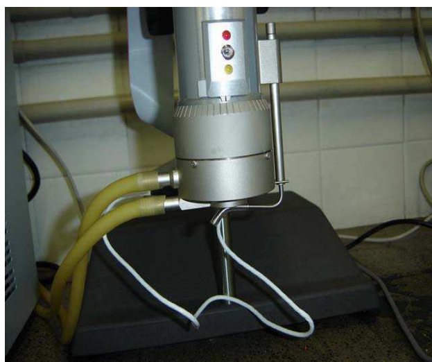
Figura III.17 – A geometria cone-placa montada no reômetro.
