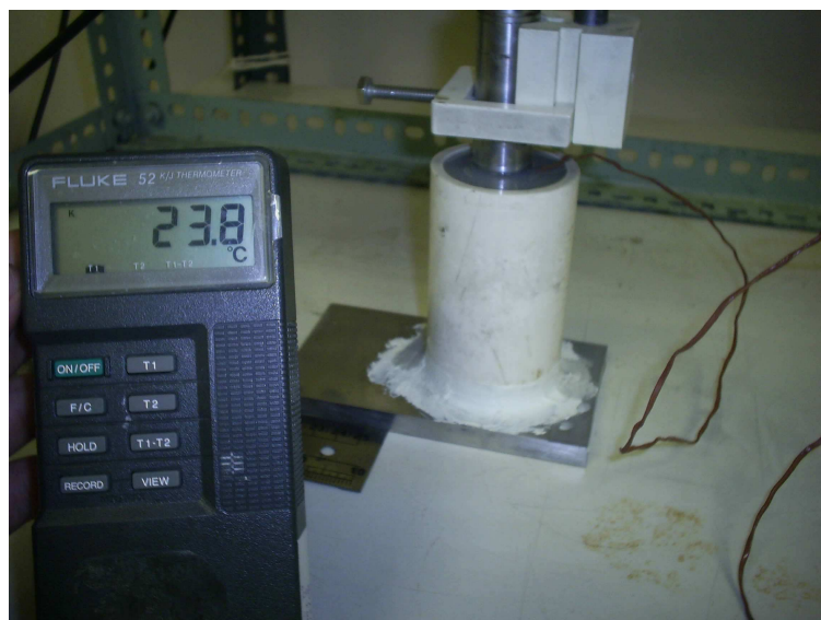
Figura III.10 – Mensuração da temperatura do FMS antes das medições acústicas, utilizando um Termômetro Digital com termopares.
