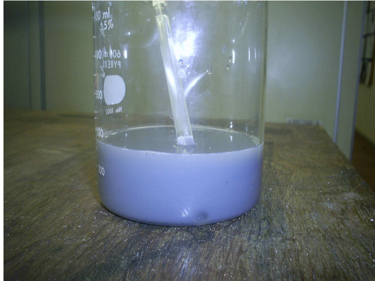
Figura III.3 – Becker com solução composta por água, glicerina, pós de grafite e PVC, detergente e polyvinylpyrrolidone, sendo misturadas para evitar a formação de grumos e manter uma maior homogeneização para as análises.
