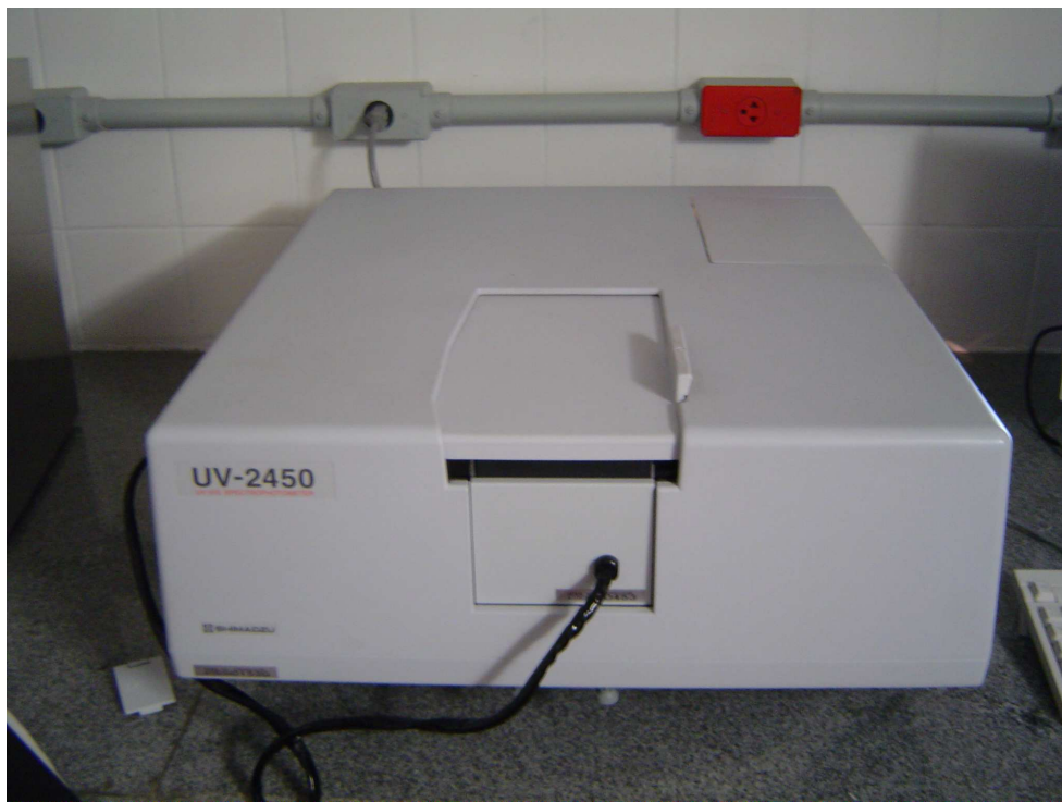
Figura IV. 10. Espectrofotômetro Shimadzu 2450 em operação no Laboratório de Fotoquímica da UFRJ.
