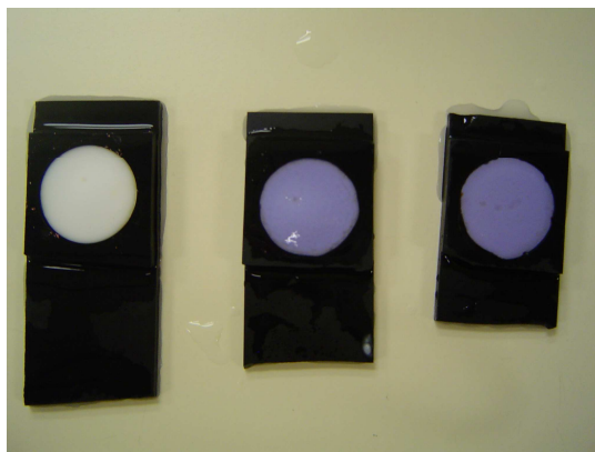
Figura V.11. Posicionadores de acrílico utilizados no experimento de espectrofotometria por refletância. Foram confeccionadas três amostras: padrão (à esquerda) e duas conforme o protocolo A (no centro e à direita).
