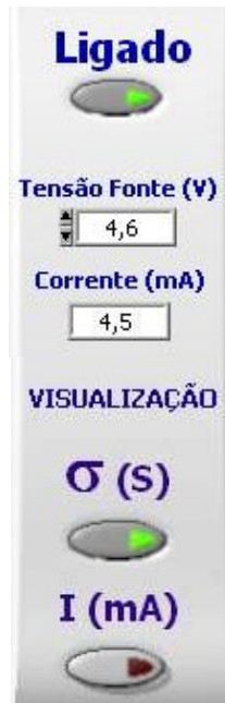
Figura 3.20 – Menu contendo a chave para acionar e desligar a comunicação do software com o hardware, indicador de corrente e um controlador de tensão. E mais duas chaves para mudar a visualização entre os três modos disponíveis: mapa de condutância; mapa de corrente e matriz de intensidade de corrente.
