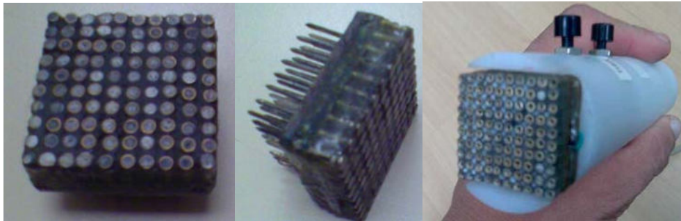
Figura 3.2 – Primeiro modelo da ponta sensora com os 64 eletrodos e os mecanismos de acionamento do software.
