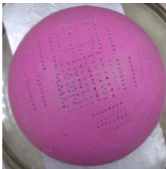
Figura 3.22 – Modelo da mama confeccionado com alginato, um material a base de algas utilizado por odontólogos e que possui propriedades condutivas.
