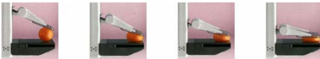
Figura 2.6 - Dispositivo de compressão da mama no Mamógrafo (extraído de SHIMADZU, 2006).
