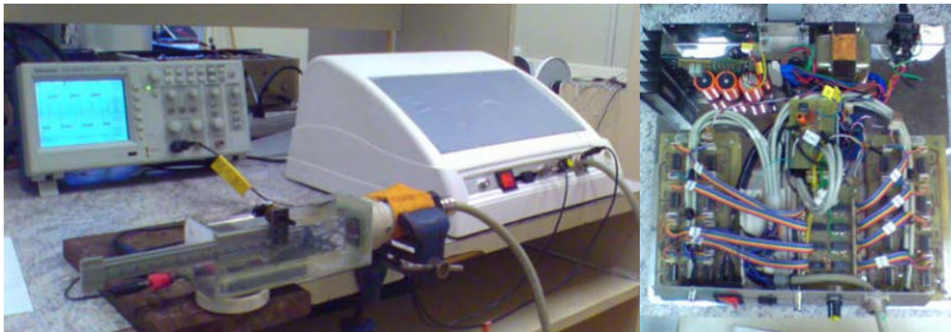
Figura 4.1 – Projeto do LibScanning com 64 pré-amplificadores.
