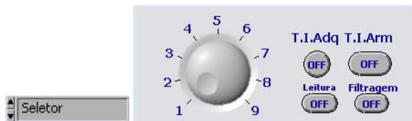
Figura 3.17 – Seletor para a seleção das imagens adquiridas ou armazenadas, mecanismos para leitura, filtragem e transferências.
