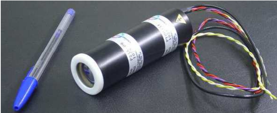
Figura 3.16: Tubo fotomultiplicador 9113B (Electron Tubes, Inglaterra) utilizado na detecção do espalhamento lateral (extraída de WANDERLEY, 2006, p. 51).
