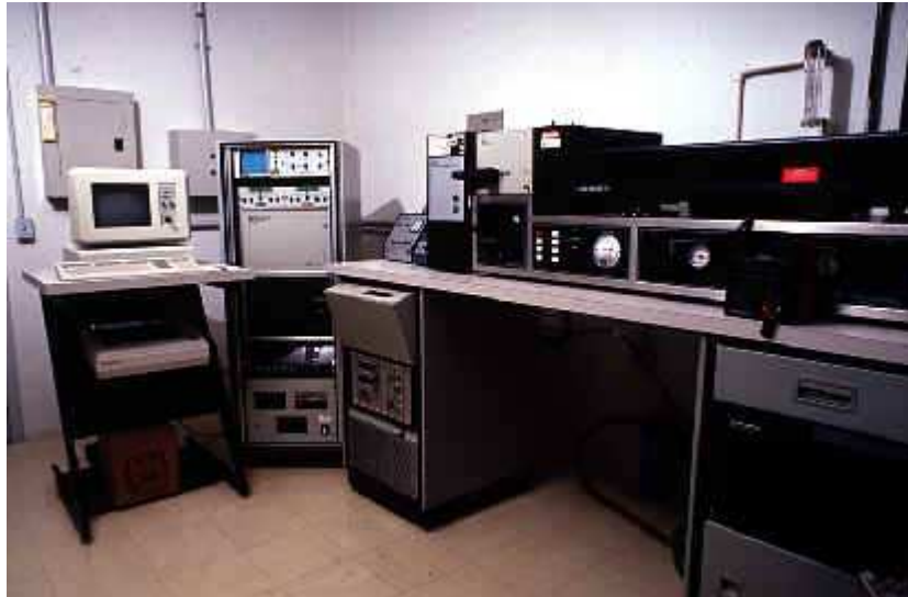
Figura 2.5: Primeiro citômetro de fluxo no Brasil: o cell sorter EPICS 751 (Beckman Coulter, EUA) (extraída do sítio do PÍCF-Fiocruz, vide BERTHO nas referências).
