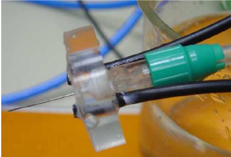
Figura 3.10: Tampa da câmara de focalização hidrodinâmica e a conexão luer-lok da mangueira com a agulha que conduz a amostra para dentro da câmara (extraída de WANDERLEY, 2006, p. 48).
