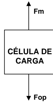
Figura 4.30 – Diagrama esquemático das forças aplicadas a célula de carga ao longo do ciclo de extensão do antebraço
