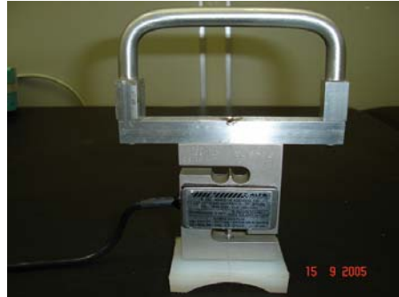
Figura 4.24 – Célula de carga e acoplamentos utilizados no sistema.
