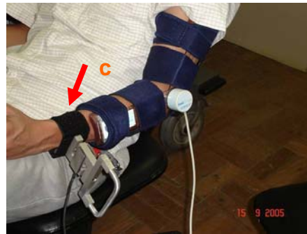
Figura 4.9 - Detalhes das adaptações para o sensor de dinamometria, fixador da célula de carga (c).
