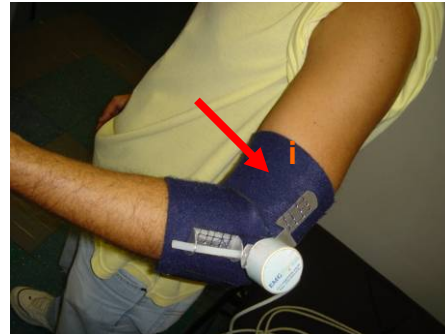
Figura 4.14 - Detalhes das novas adaptações para o sensor de goniometria: fixador do goniômetro no cotovelo (cotoveleira) (f).
