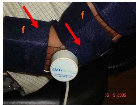
Figura 4.12 - Detalhes das adaptações para o sensor de goniometria, fixador do goniômetro no cotovelo (f).
