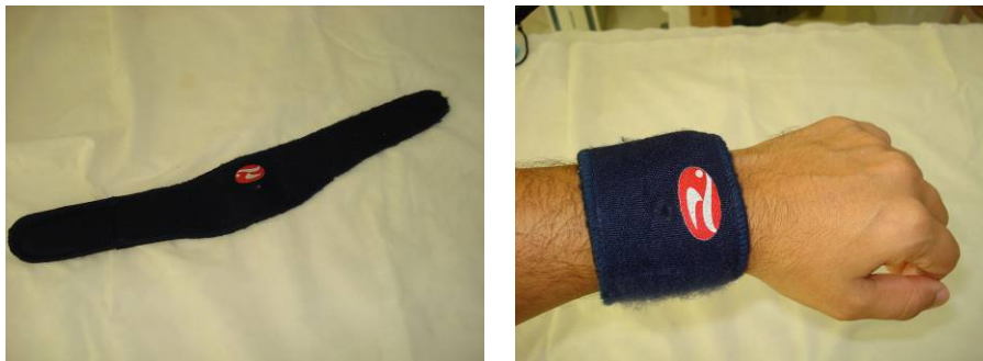
Figura 4.10 – Aparato de fixação (tipo elástico) da célula de carga adotado no experimento piloto.
