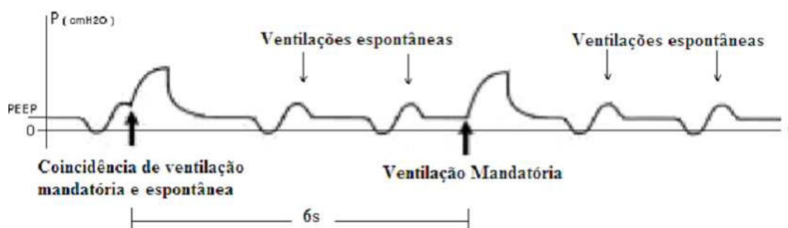
Figura 4. Ventilação mandatória intermitente (IMV). Curva de pressão em função do tempo nas vias aéreas, frequência de 10cpm. Observa-se que a ventilação mandatória pode coincidir com a espontânea.
