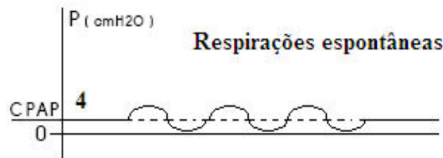
Figura 6. Pressão positiva contínua nas vias aéreas (CPAP). Curva de pressão em função do tempo nas vias aéreas, PEEP de 4 cmH 2 O.
