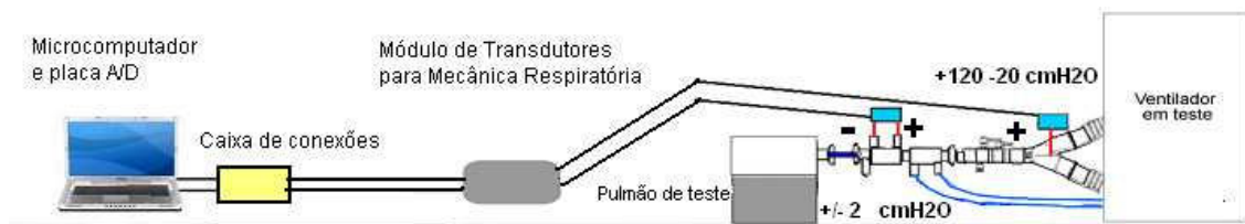
Figura 15. Montagem dos equipamentos para o ensaio de forma de onda, desempenho de volume e ensaio de alarmes.
