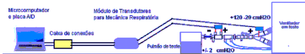
Figura 1: Montagem dos equipamentos para o ensaio
