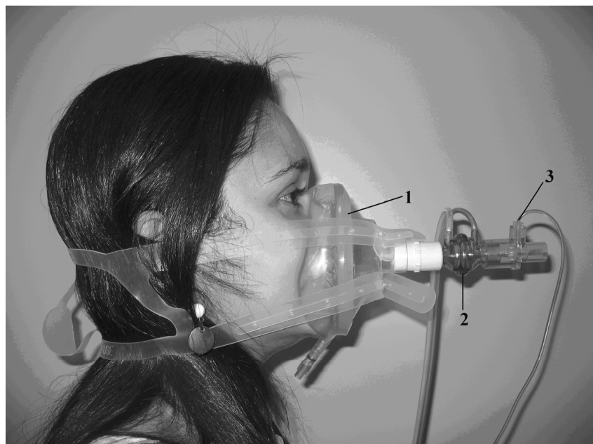
Figura III.1 – Montagem experimental concebida para medir os parâmetros ventilatórios, composta por uma máscara facial conectada a tubos. Legenda: 1 – máscara facial; 2 – pneumotacógrafo (PTC); 3 – saída para a capnometria
