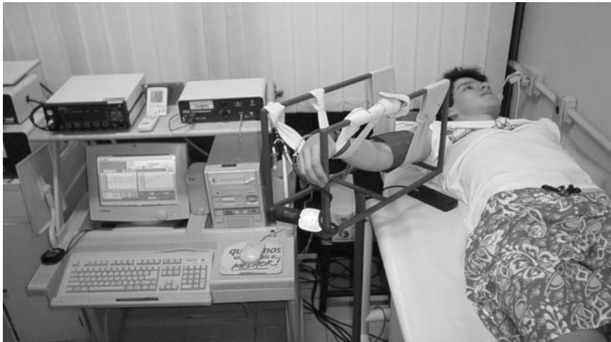
Figura 4.3: Aparato experimental para a pletismografia. Fotografia cedida pelo LACE/ UFF.
