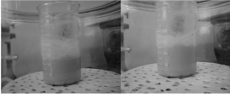
**Figura III.3 – *Becker* contendo solução composta por água, glicerina e pós de Grafite e PVC, no interior de um dissecador com vácuo, onde se realiza a retirada de bolhas de ar dessa solução.**
