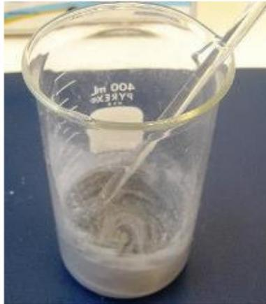
**Figura III.2 – Becker com solução composta por água, glicerina e pós de Grafite e PVC, sendo misturadas com detergente a fim de garantir homogeneização, não permitindo a formação de grumos na solução.**
