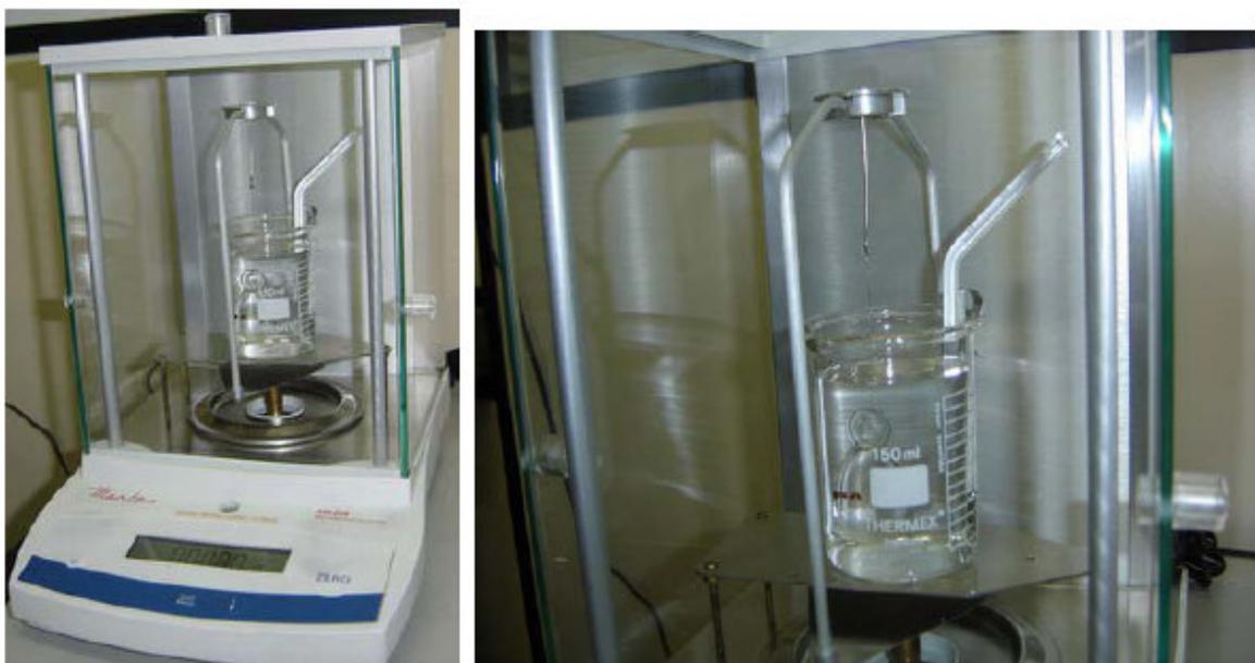
**Figura III.15 Densímetro operando no LTTC**
