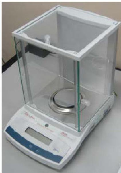
**Figura III.14 Balança AM220 da Marte**
