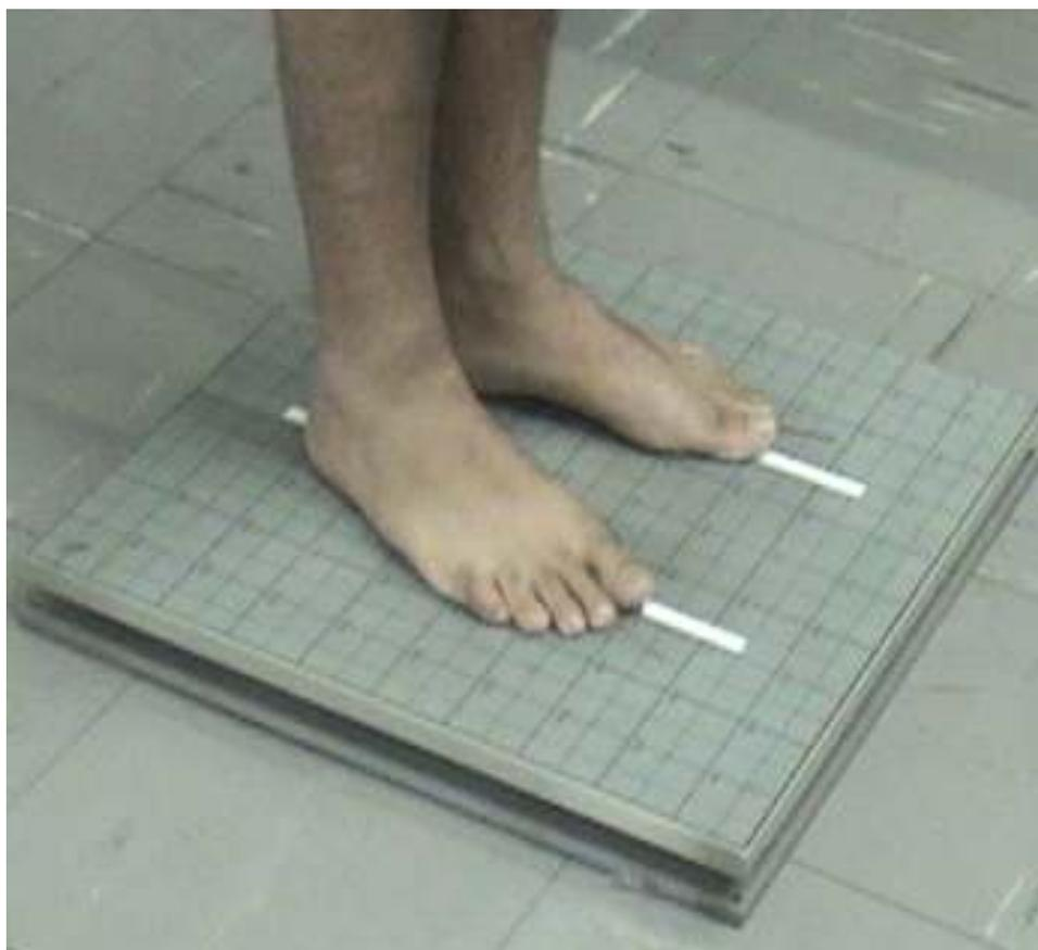
**Figura III.1 –Posicionamento dos pés sobre a plataforma de força. Duas marcas posteriores são separadas de 6 cm, devendo ser sobrepostas pelos calcanhares, enquanto as marcas anteriores formam um ângulo de 10° de abdução dos pés.**
