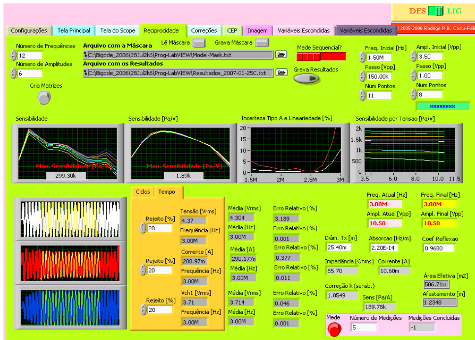
Figura IV.7: Janela designada “Reciprocidade”. Nesta tela colocam-se os parâmetros das faixas de frequência e de tensão do transdutor. Além disso, permite visualizar o pulso gerado antes do resistor (sinal branco), depois do resistor (sinal azul) e a captação do eco (sinal vermelho). Ao término das aquisições o programa constrói quatro gráficos nos quais são apresentadas as curvas de sensibilidades calculadas de duas formas diferentes: o primeiro gráfico utiliza a corrente de emissão e o segundo gráfico a tensão de emissão, as curvas da incerteza do método do Tipo A e a linearidade e a curva da sensibilidade em função de tensão de alimentação para cada uma das frequências utilizadas.
