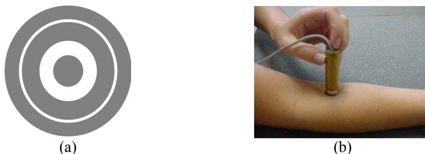
**Figura 28** – Ilustração do *probe* (primeira versão) utilizado para medir a bioimpedância da pele. Os anéis internos e externos são os eletrodos ativos e o anel intermediário é usado como eletrodo de guarda (a); aplicação do *probe* sobre a pele no antebraço anterior (b).
